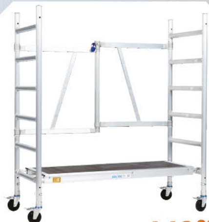
VOUWSTEIGER VSC Ht 2,7m. Compact. 1,75 x 0,70m. Platformhoogte 1m. EN 1004. 308029/D
